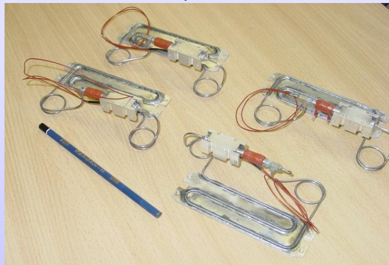
Аммиачные регулируемые КТТ с 8-мм испарителем, номинальная мощность – 40 Вт
