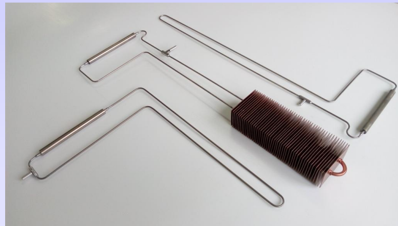
Аммиачные КТТ с 8-мм испарителем, номинальная мощность – 100 Вт
